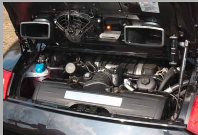
Hier Boxen 6 Zylinder die 385 PS aus 3800ccm Hubraum in 4,9 Sekunden auf 100 Km/h
